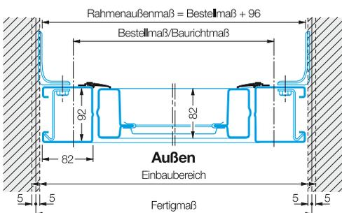
Der Einbau in der Öffnung ist maßlich genauer abzustimmen, insbesondere bei Toren in Normgrößen. Tore in Sondergrößen werden genau für die vorhandene Öffnung angefertigt.
