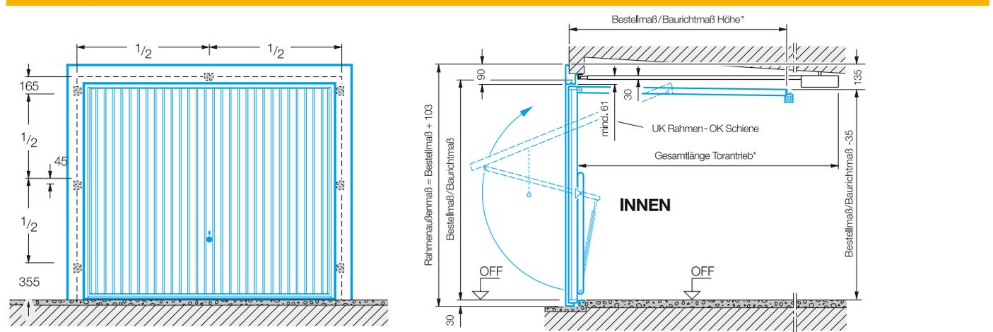
\* Gesamtlänge Torantrieb ProMatic/SupraMatic 3200 mm bis Torhöhe 2500 mm
