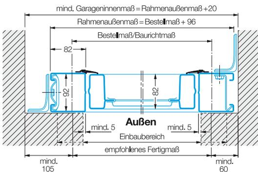
Das Fertigmaß wird für die Planung vorgeschlagen. Mindestanschläge, Sturzhöhe und Einbaubereich beziehen sich auf dieses Maß.
