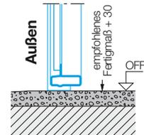
Das empfohlene Fertigmaß wird für die Planung vorgeschlagen. Mindestanschläge, Sturzhöhe und Einbaubereich beziehen sich auf dieses Maß.
