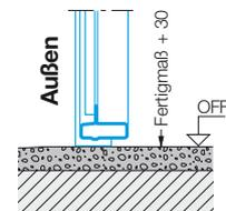
Der Einbau in der Öffnung ist maßlich genauer abzustimmen. Insbesondere bei Toren in Normgrößen. Tore in Sondergrößen werden genau für die vorhandene Öffnung gefertigt.
